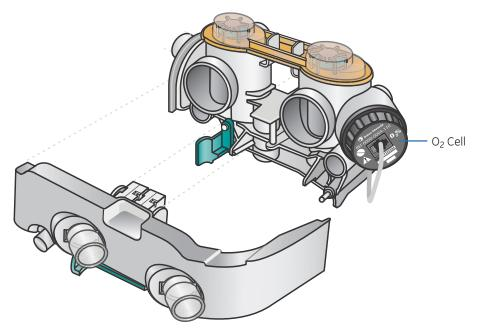
Figure 2.9 O<sub>2</sub> Sensor
