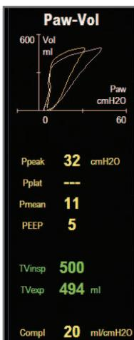
Esta imagen muestra los efectos de distintos ajustes de la PEEP (y por ende, de las maniobras de reclutamiento) en la compliance del paciente. El bucle guardado (blanco) indica una compliance reducida. La situación se ve alterada al aumentar el ajuste de la PEEP hasta 5 cm H<sub>2</sub>O, que obviamente mejora la compliance pulmonar (amarillo).
